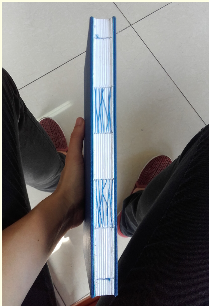
Exemplo de livro com costura aparente feita em máquina. Esse exemplar foi feito na gráfica Arrisca que também foi visitada.
